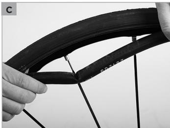
Achten Sie darauf, dass der Schlauch nicht zwischen Reifen und Felge eingeklemmt und gequetscht wird. Schieben Sie den Schlauch von Hand immer wieder ins Reifeninnere **(c)**.
