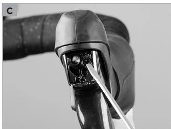
Bei **SRAM** verstellen Sie zuerst die Kurvenscheiben an den leicht zurückgezogenen und eingeschwenkten Schalthebeln. Danach drehen Sie die versteckt unter dem Griffgummi im Körper liegende Schraube mit einem Innensechskantschlüssel (**e**) hinein.
