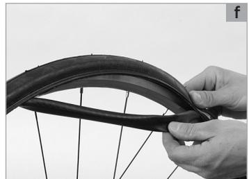
Bei Felgen mit doppeltem Boden, sogenannten Hohlkammerfelgen, muss es den ganzen Boden überspannen, darf aber nicht so breit sein, dass es an den Flanken hochsteht. Solche Felgen sollten Sie nur mit Bändern aus Textilgewebe oder festem Kunststoff kombinieren. Wenn Sie sich nicht absolut sicher sind oder Fragen haben, wenden Sie sich an Ihren SCOTT-Fachhändler.
