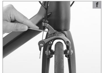
Verschleißt der Belag, wandert der Druckpunkt am Bremshebel immer weiter zum Lenker hin. Kontrollieren Sie den Leerweg regelmäßig, dieser sollte nicht mehr als ein Viertel des gesamten Weges betragen. Drehen Sie zum Nachstellen so lange an der Rändelmutter bzw. gerändelten Schraube **(d)**, durch die der Zug am Bremskörper hindurch läuft, bis der Hebelweg Ihren Ansprüchen genügt. Probieren Sie die Bremsen anschließend an einem unbelebten Ort aus.
