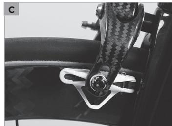
Die Felge kann zerstört werden, ein möglicher Schlauchplatzer kann zum Unfall führen. Verzögern Sie grundsätzlich mit beiden Bremsen und lassen Sie die Bremsen dann immer wieder einige Zeit los, damit sich das Material abkühlen kann. Halten Sie im Zweifel an und lassen Sie abkühlen.
