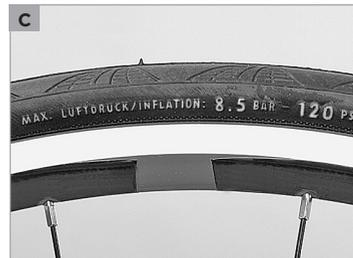
Draht- und Faltreifen allein sind mit der Felge nicht luftdicht. Um den Druck im Inneren zu halten, wird ein Schlauch eingelegt (**f**) und durch ein Ventil befüllt.
