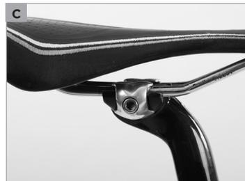
Beim **Ein-Schraubensystem (c)** ist die Sattelstütze für die meisten Sportsättel mit einem Sattelgestellrohrdurchmesser von 7 mm ausgelegt.
