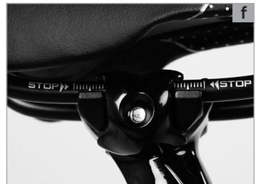
Stellen Sie zudem die Satteloberkante parallel zum Untergrund ein. Drehen Sie die Schraube schrittweise an und stellen Sie sicher, dass
