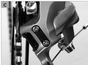
Schauen Sie von hinten auf den Zahnkranz und prüfen Sie, ob die obere Leitrolle des Schaltwerks genau unter den Zahnspitzen des Ritzels liegt. Korrigieren Sie die Position ggf. mit der Endanschlagschraube **(d)**. Bei Schaltwerken sind die Schrauben oft mit „H“ für „high gear“ und „L“ für „low gear“ gekennzeichnet. „High gear“ steht in diesem Fall für den schweren Gang, also das kleine Ritzel.
