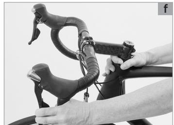
Um die Leichtgängigkeit des Lagers zu prüfen, heben Sie mit einer Hand den Rahmen hoch, bis das Vorderrad keinen Bodenkontakt mehr hat. Das Vorderrad muss ohne Einrasten von ganz links nach ganz rechts und zurück schwenken. Wenn Sie den Lenker leicht antippen, muss sich die Gabel selbsttätig aus der Mittelstellung herausdrehen **(a)**.
