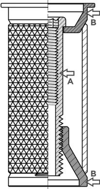
5. Verwenden Sie einen 6-mm-Innensechskantschlüssel um die Expanderschraube zu lösen **(A)** bis die oberen und unteren Spannkeile **(B)** frei drehbar sind.
